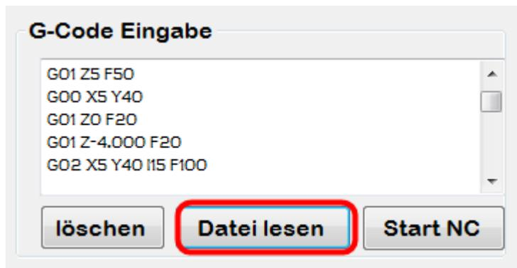
Die Ausführung des G-Codes wird mit **Start NC** ausgelöst.
